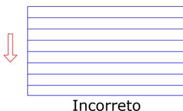
02) É necessário selar os alvéolos da chapa, na parte superior com fita de alumínio impermeável, que impede o acesso de água e insetos nos poros, e na parte inferior fita porosa para o respiro da chapa, pois desta maneira evitamos a formação de manchas.
